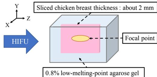
Fig. 2 Thin film phantom.
